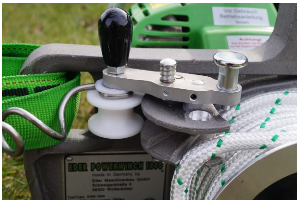
Abb. 20: Führen des Seils durch die Seilklemme
