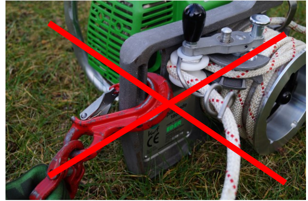
Abb. 23: falsche Befestigung der EDER Powerwinch 1800
