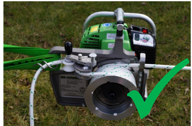
Abb. 24: richtige Befestigung der EDER Powerwinch 1800
