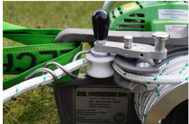
Abb. 22: Führen des Seils durch die Seilklemme und durch den Umlenkhooken
